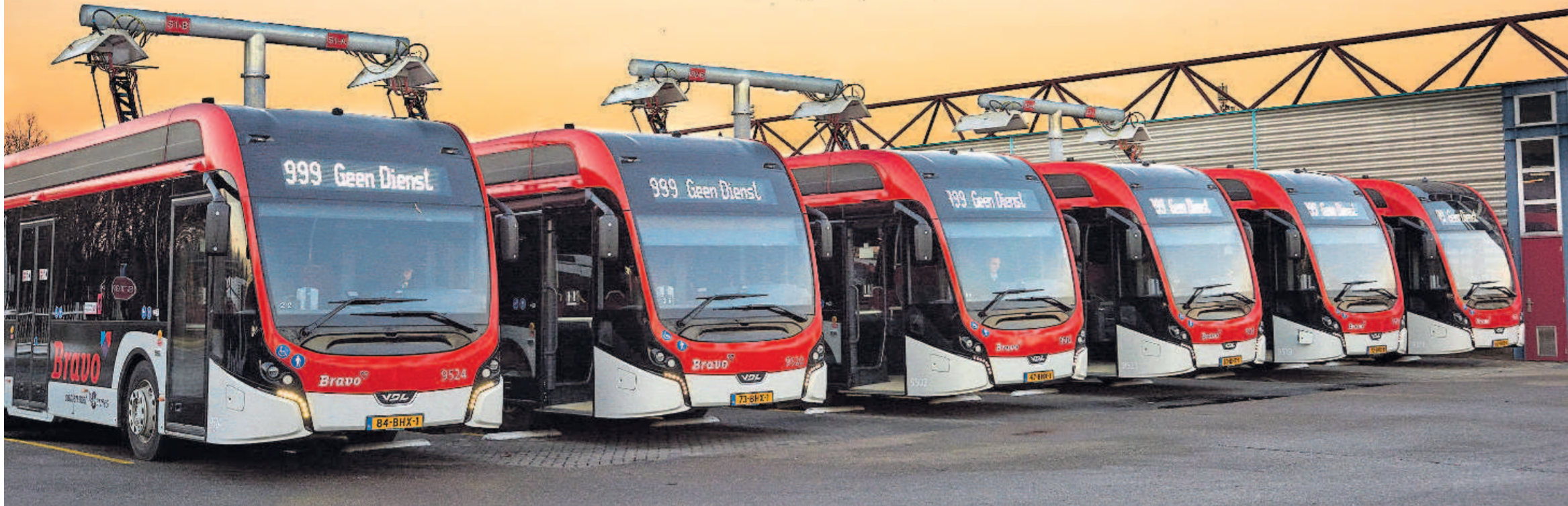
Lademeister: In Eindhoven fahren seit Ende 2016 ausschließlich elektrische Busse. Auf diesem Foto haben sie dienstfrei und hängen im Depot an der Ladestation.
